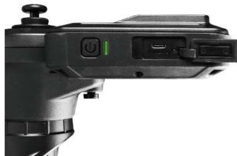
USB type-C連結電腦作視訊輸出或傳輸SD卡檔案應用
