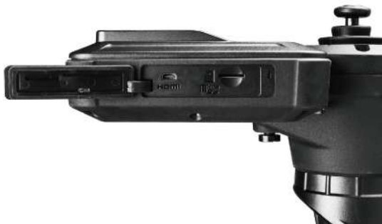
mini HDMI port連結大螢幕輸出影像
